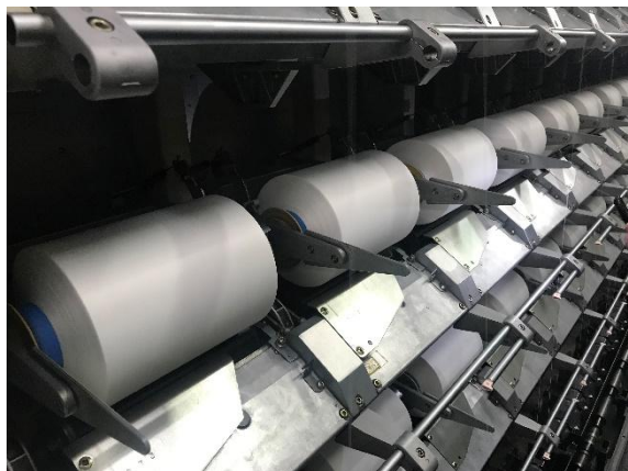
仮撚り機 糸の巻取り工程
