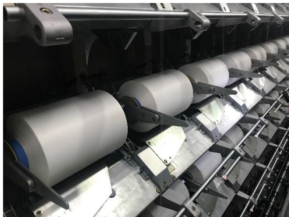
仮撚り機 糸の巻取り工程
