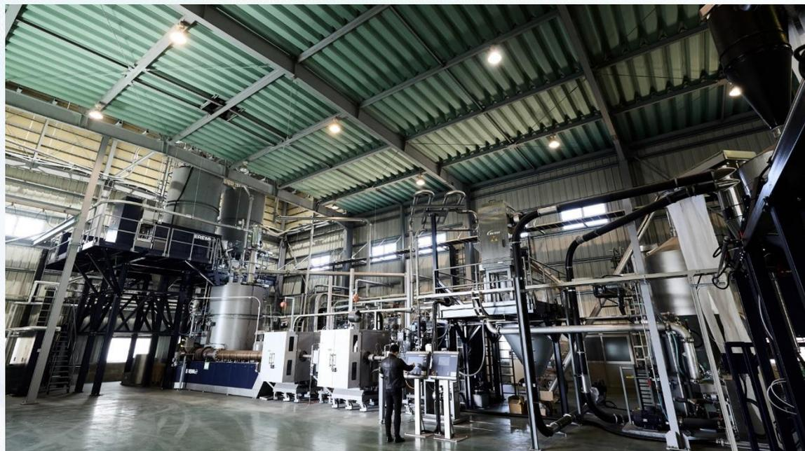
2019年からペットボトルリサイクルのリーディングカンパニーであるウツミリサイクルシステムズ(株)と協業し、当社のリサイクル設備を大阪府泉南市に保有。同社の工場にて粉碎・洗浄した廃ペットボトルを繊維等の原料（ペレット）に戻すことが可能。FDA（米食品医薬品局）が安全性を認可した最新の設備で、繊維だけではなく、飲料ボトルや食品トレーにも使えるほど安全かつ高品質な原料を製造する。
