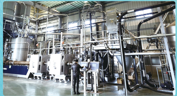
リサイクルペレット製造の押出機
