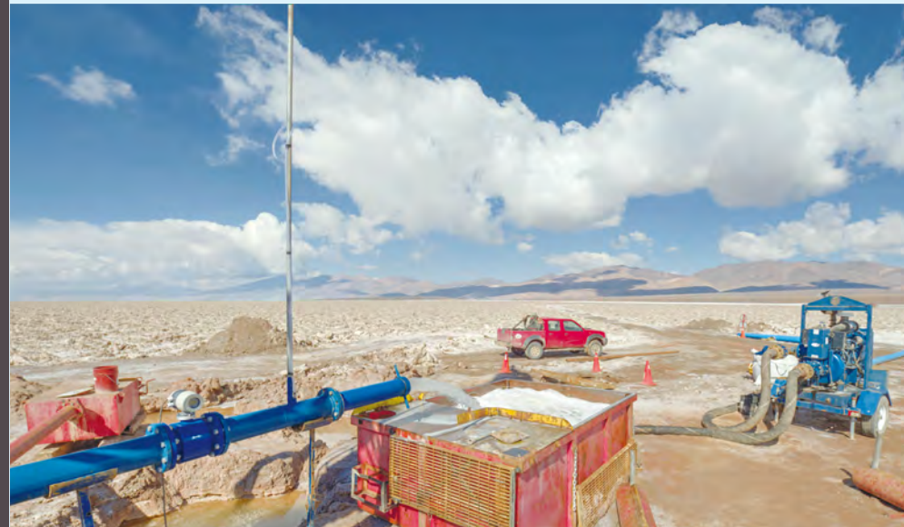
塩湖に含まれるリチウム成分を取り出す様子。リチウムは広大な塩湖の下の地下水中に存在している。
