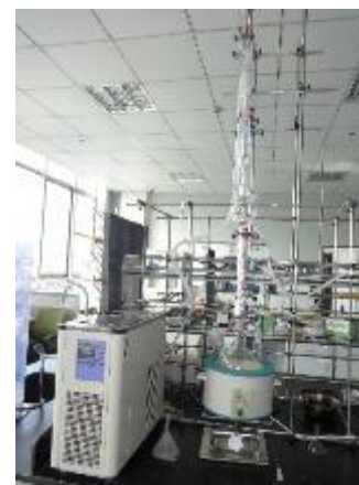
溶媒精留 回収装置
